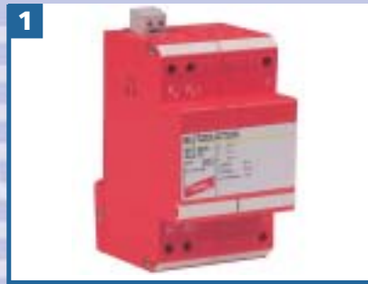
1 BLITZDUCTOR® VT KKS BVT KKS ALD 75 Art.-Nr. 918 420 Blitzstrom- und Überspannungs-Ableiter zum Schutz aktiver Korrosionsschutz-Anlagen (Anodenstromkreis) mit integriertem Fernmeldekontakt. Einbau in Stahlblechgehäuse empfohlen Lightning current and surge arrester for protection of active corrosion protection installations (anode electrical circuit) with integrated remote signalling contact. Installation in steel plate enclosure recommended.
