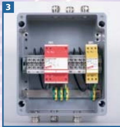
3 ITAK KKS Art.-Nr. 989 406/S; Serien-Nr. 4305 Anschaltkasten aus Aluminium, IP 65, zum Schutz von KKS-Anlagen, komplett bestückt mit Blitzstrom- und Überspannungs-Ableitern vom Typ BVT KKS ALD 75 + BVT KKS APD 36 Aluminium connection box, IP 65, for protection of CP installations, completely equipped with lightning current and surge arrester type BVT KKS ALD 75 + BVT KKS APD 36
