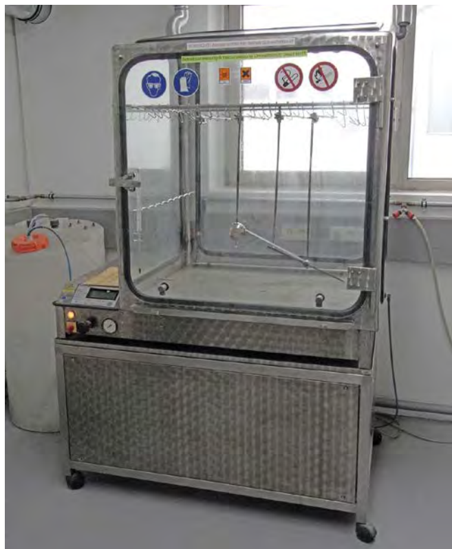
Bild 2: Prüfungen mit dem Kesternichgerät.
