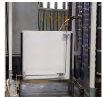
Bild 5: Auf Isolierplatte befestigter Prüfling (MV-Klemme) für Test im Stoßstromlabor.
