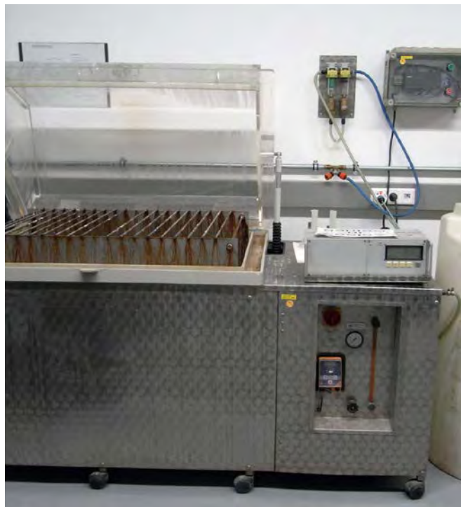
Bild 1: Prüfungen mit einer Salzsprühtruhe.
