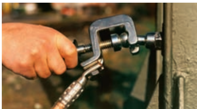
通用接地夹具带手柄用于连接接地球
