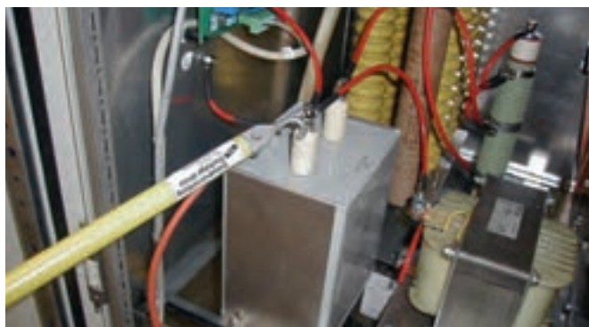
单极放电操作杆用于静电泄放
