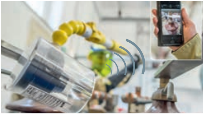
对绝缘体的后侧进行带电检查
