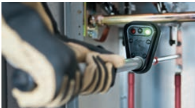
PHE电压探测器带可视指示
