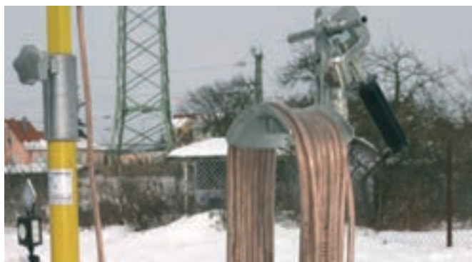
带成卷接地电缆的接地钉
