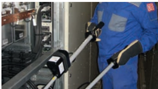
PHE / G II直流电压探测器，用于直流供电装置（ICE操作端）
