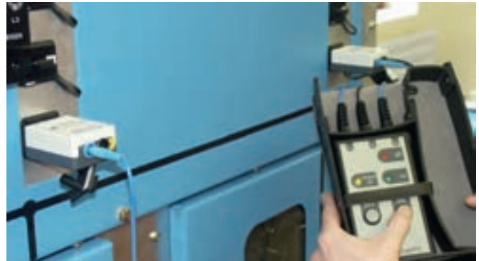
DEHNcap / PC-LRM相位比较器带两个HR-LRM测试头，是用于HR 开关设备内
