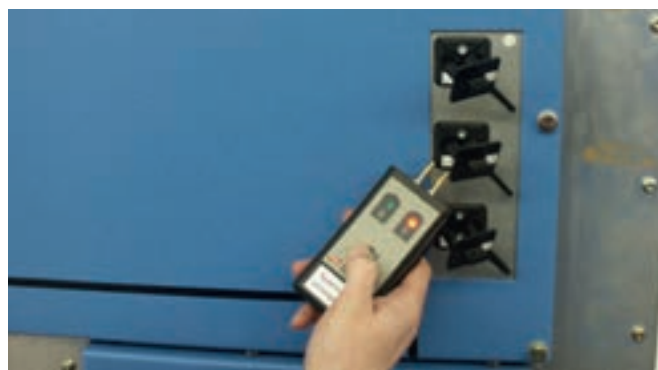
DEHNcap / A电压指示器进行自测
