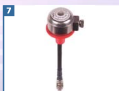
EXFS L100 Référence 923 060 Eclateur ATEX protégé contre le risque d'explosion, pour les zones Ex (zone 2), pour la protection contre les surtensions et les courants de foudre ATEX certified spark gap for use in hazardous areas (zone 2) for protection against overvoltages and lightning currents
