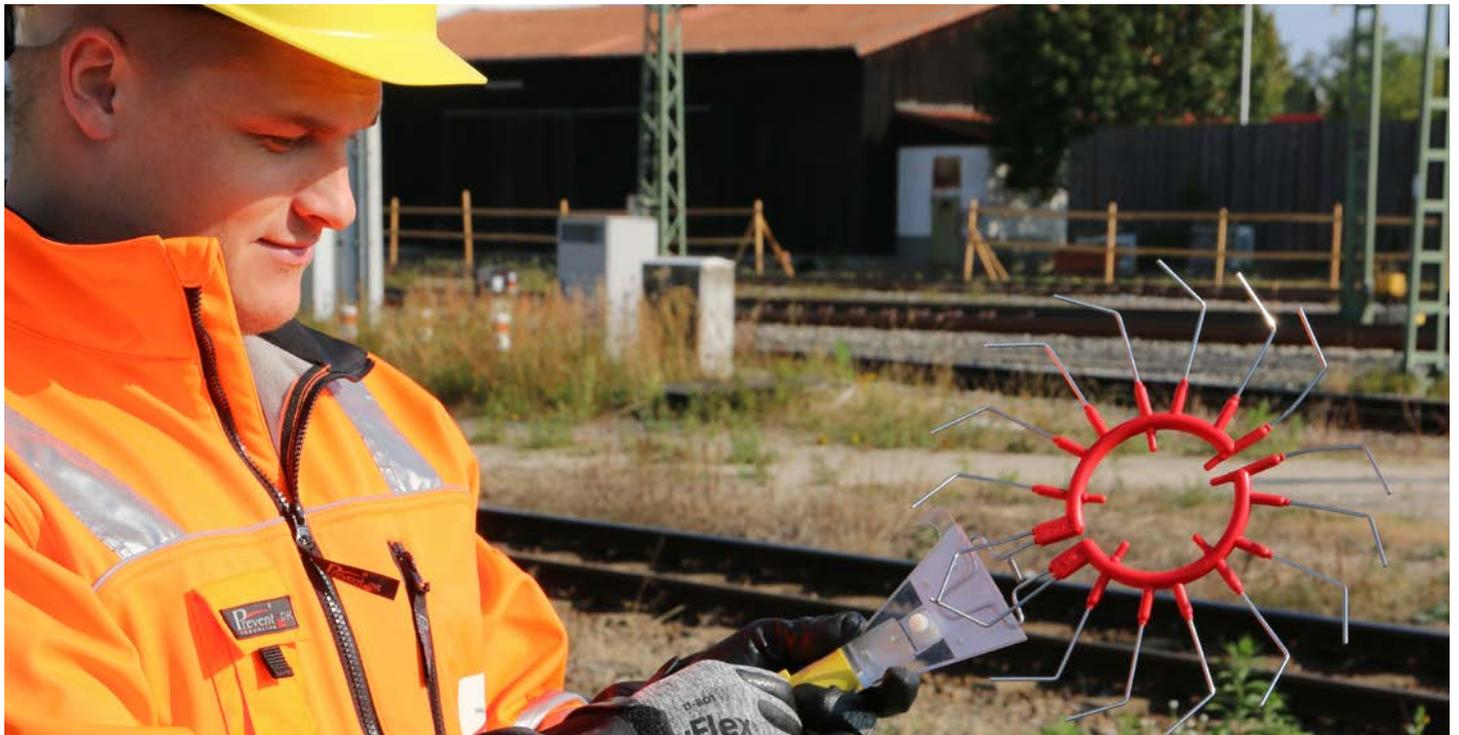
Mit dem neuen **Adapter AD ZK 3M 170** kann schnell und bequem der Vogel- und Kleintierschutz **Animal Guard™** von 3M auf Isolatoren montiert werden. So verhindern Sie Lichtbögen, die zum Tod von Vögeln und Kleintieren durch elektrischen Strom führen. Der Bahnverkehr wird nicht durch Erd- und Kurzschlüsse beeinträchtigt.
