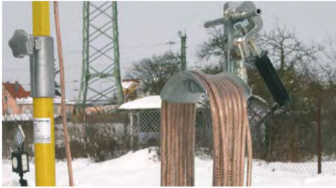
Erdungsspieß mit aufgewickelter Erdungsleitung.
