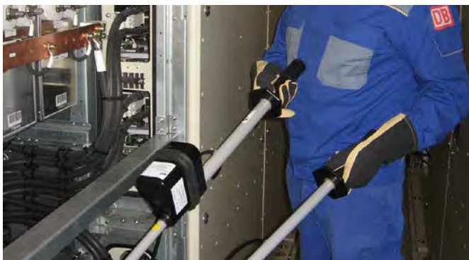
Gleichspannungsprüfer PHE/G II für Gleichstromzwischenkreise (ICE-Triebkopf).
