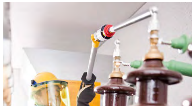
Prüfkopf PHE III mit Universalzahnkupplung und Isolierstange.
