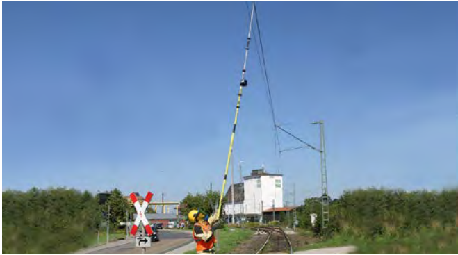
Spannungsprüfer PHE mit optischer Anzeige an einer Fahrdrathleitung der Deutschen Bahn.
