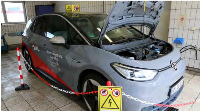
Gut sichtbare Warnschilder am E-Fahrzeug.
