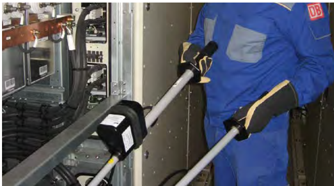
Gleichspannungsprüfer PHE/G II für Gleichstromzwischenkreise (ICE-Triebkopf).
