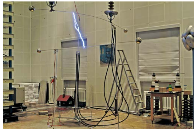
Figure 6 : test de haute tension selon IEC TS 62561-8 édition 1.0 de janvier 2018 d'un système HVI avec quatre conducteurs HVI.
