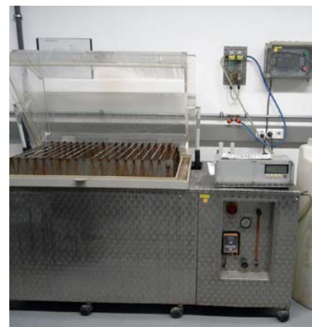
Figure 1 : tests dans un coffre d'aspersion de solution saline
