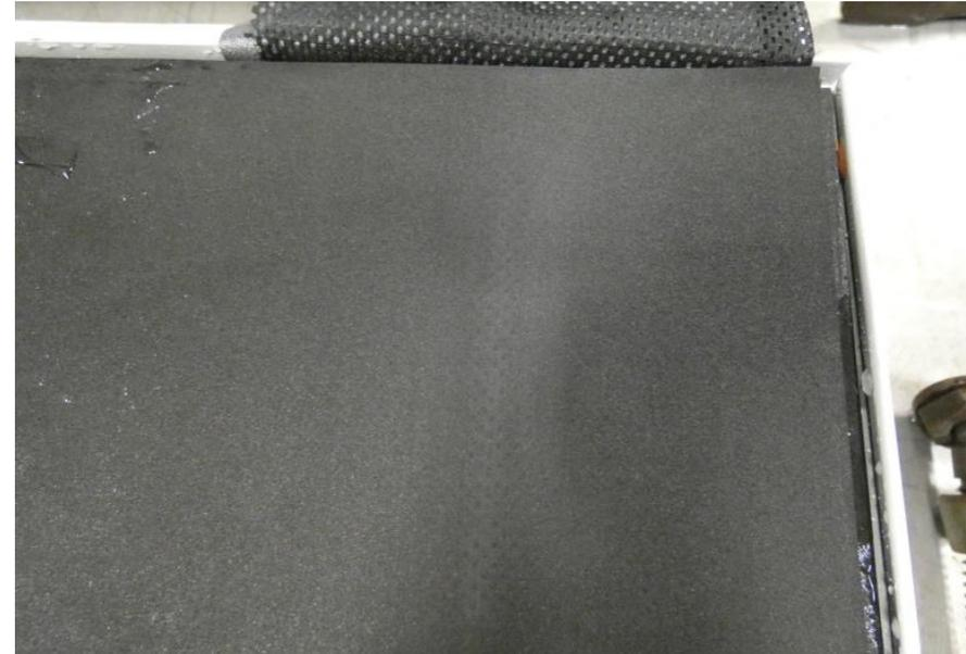
Unter dem zurückgeklappten Schutzstoff ist der Indikator, das genormte Moosgummi, unverletzt und ohne Befund.
