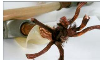
Ca. 30 Jahre alte Garnitur mit Querschnittsminderung durch Kupferkorrosion.
