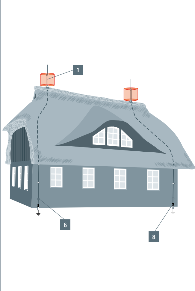
Protezione di una struttura a tetto morbido con conduttura HVI
