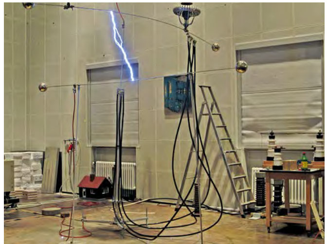
Figure 6: Prova ad alta tensione in accordo alla IEC TS 62561-8 edizione 1.0 2018-01 di un sistema HVI con quattro condutture HVI.
