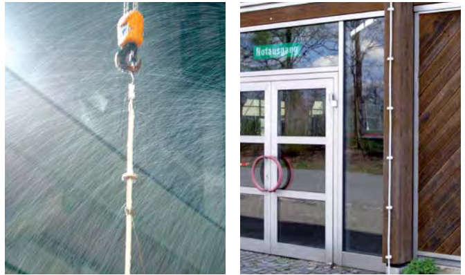
Figura 4: Prova d'isolamento sotto pioggia
