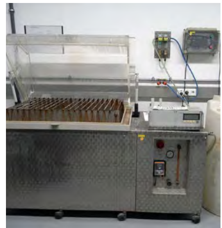
Figura 1: Prove in apparecchio con sale nebulizzato
