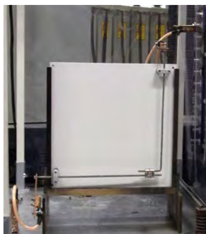
Figura 5: Provino fissato su piastra isolante (morsetto MV) per la prova ad impulso.
