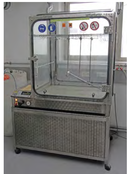
Bild 2: Prüfungen mit dem Kesternichgerät.
