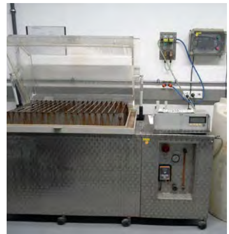
Bild 1: Prüfungen mit einer Salzsprühtruhe.
