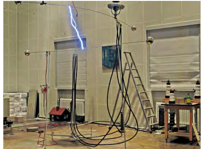
Bild 6: Hochspannungsprüfung nach IEC TS 62561-8 Edition 1.0 2018-01 eines HVI-Systems mit vier HVI Leitungen.
