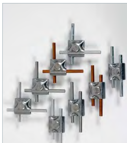
Bild 4: Prüfkombinationen für MV-Klemme (Parallel- und Kreuzanordnung).
