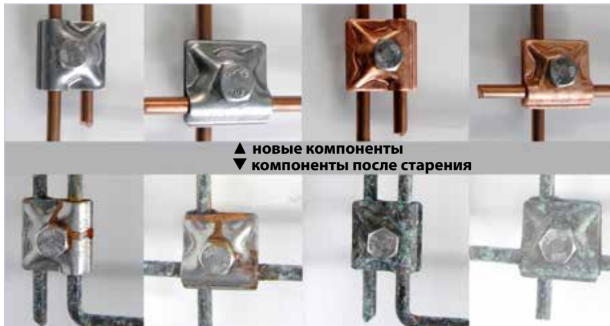
Рис. 3. Новые компоненты и компоненты после старения
