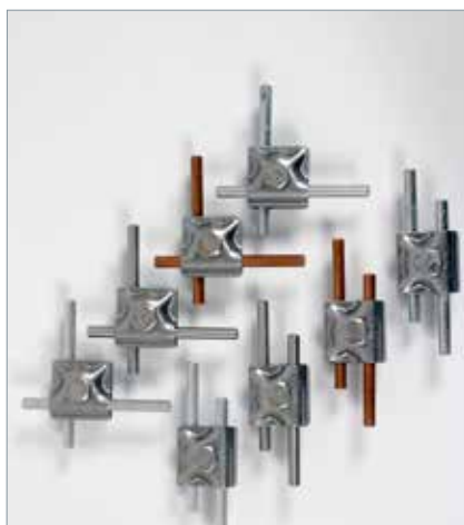
Рис. 4. Комбинации для тестирования клемм MV (параллельное и крестообразное соединение)
