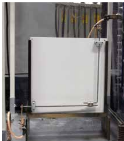
Рис. 5. Образец (клемма MV), закрепленный на изоляционном щите в лаборатории импульсных токов
