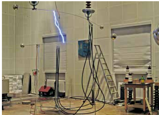
Рис. 6. Испытание высоким напряжением системы с четырьмя токоотводами HVI в соответствии со стандартом IEC TS 62561-8 издание 1.0 2018-01.
