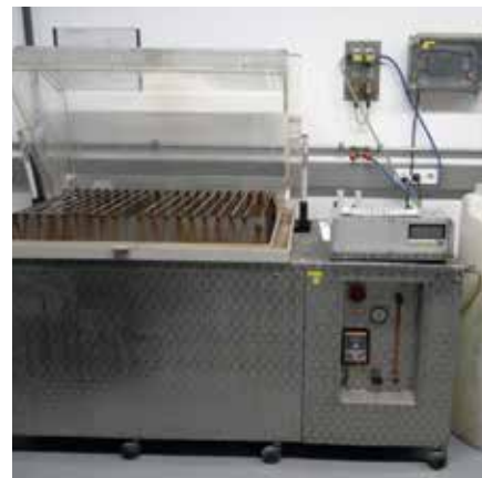
Рис. 1. Тестирование на воздействие солевого тумана
