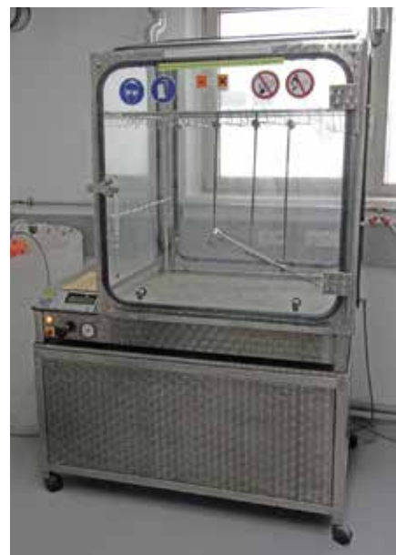
Рис. 2. Тестирование на воздействие сернистой атмосферы
