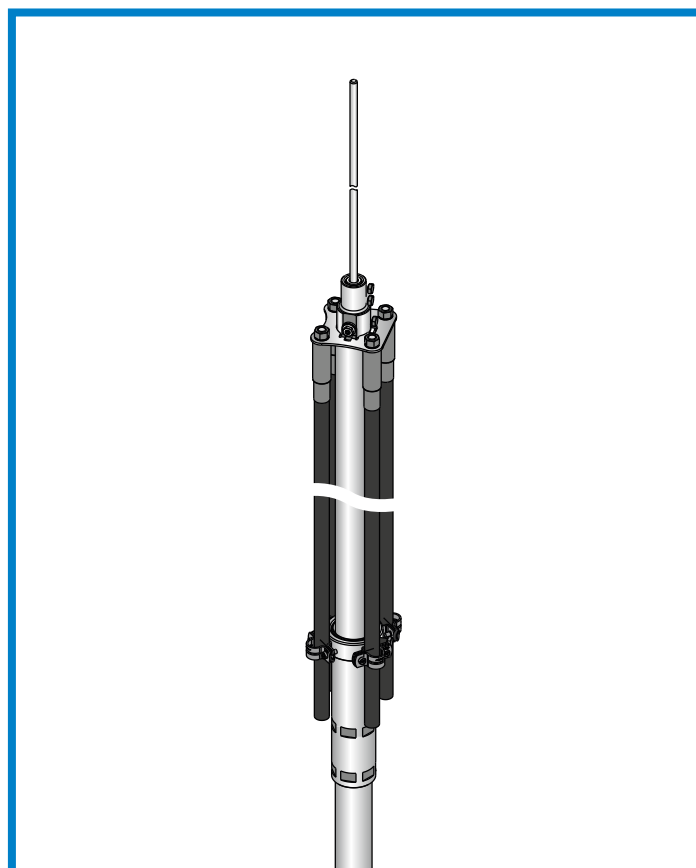
10. ábra Támasztócsövön kívül történő szerelés, 5. lépés
