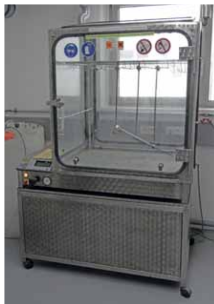
Obrázek 2: Kesternichův test v komoře se siřičitou atmosférou
