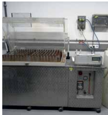
Obrázek 1: Zkoušky v komoře se slanou mlhou
