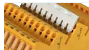
Zdíčky pro zasunutí propojovacího modulu umožňují rychlé propojení signálních okruhů.
