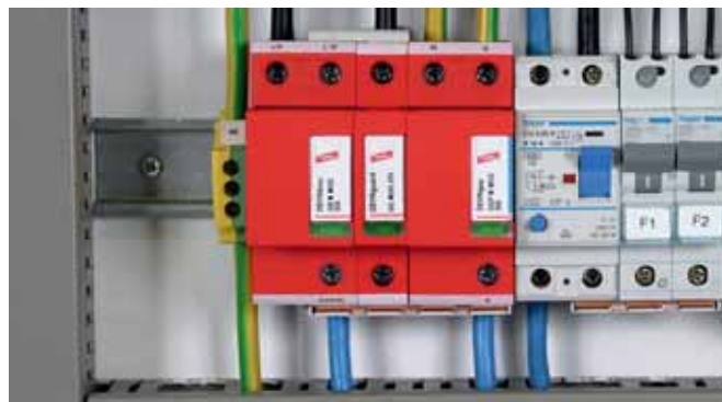
Chrání zařízení a spotřebiče připojené k síti nízkého napětí i při přímých úderech blesku. Instalace na rozhraní zón ochrany před bleskem LPZ 0 A – 1 ve variantě zapojení 3+1.
