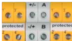
Rozhraní RS485 A/B (pouze u DRC MCM XT) pro komunikaci a veliny.
