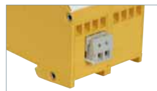
Samostatná uzemňovací svorka na nechráněné straně svodiče. Svorka je zdvojená, druhá slouží k přímému propojení koncového zařízení se systémem vyrovnání potenciálu.
