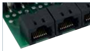
Provedení se zdičkami RJ45 pro dovybavení stávajících zařízení.
