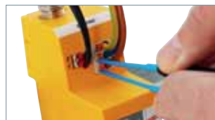
Integrované měřicí otvory pro testování signálových obvodů měřícím hrotem.
