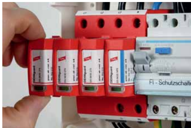
Chrání nízkonapěťová zařízení před přepětím. Instalace na rozhraní zón ochrany před bleskem LPZ 0 B – 1 a vyšších.
