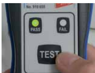
Intuitivní ovládání a rychlá kontrola svodičů (M1+).
