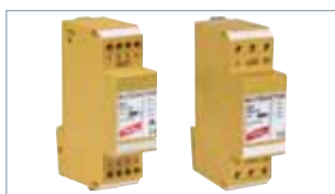
Varianta těla svodiče BVT s jednotnou šířkou 1,5 modulu a šroubovými svorkami: BVT AV/LD: 2 chráněné žíly pro DC napájecí systémy BVT (M)TTY: 4 chráněné žíly
