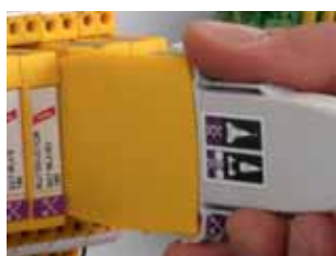
Měřicí senzor se západkami pro nasazení na ochranný modul.
