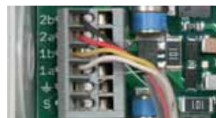
Volitelně přímé nebo nepřímé uzemnění stínění kabelu (DBX U4/U2 KT BD S 0 - 180).
