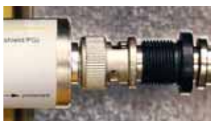
UGKF BNC se nasunuje přímo na koaxiální konektor koncového zařízení.
