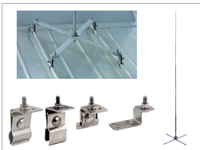
Rys. 6. Maszt odgromowy do ochrony instalacji PV na dachach z metalowym pokryciem o kącie pochylenia do 10° oraz wsporniki mocujące
