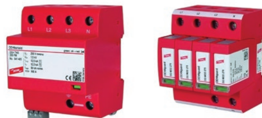
Rys. 4. Ograniczniki przepięć do ochrony stacji ładowania pojazdów elektrycznych: a) kombinowany ogranicznik przepięć typu 1 – DEHNshield, b) warystorowy ogranicznik przepięć typu 2 – DEHNgard Fig. 4. SPDs for the protection of electric car charging stations: a) type 1 combined lightning current and surge arrester DEHNshield, b) varistor-based type 2 surge arrester DEHNgard
