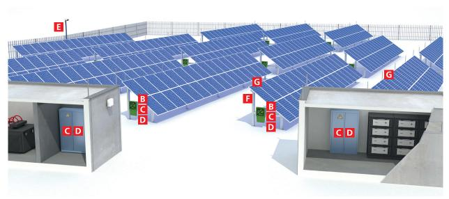
Si las plantas fotovoltaicas de autonsumo en tierra se diseñan con inversores de string monofásicos descentralizados, gran parte del cableado se desplaza del lado de DC al de AC. En caso de impacto directo de un rayo, el cableado de AC actuará como conductor de corrientes parciales de rayo. Por esta razón, los se utilizan en el lado AC. descargadores tipo 1 +2
