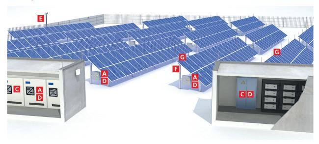
Las pequeñas plantas de autoconsumo en tierra, con diseño de inversores centrales, poseen gran cantidad de cableado de corriente continua.
