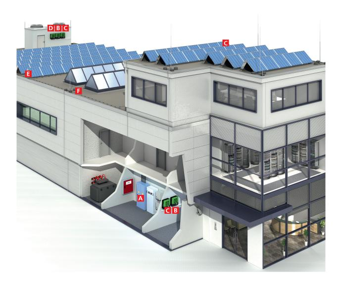
Si no se puede mantener la distancia de separación "s", se requiere una conexión equipotencial de rayo.
