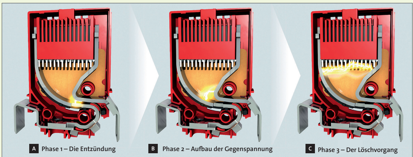
Bild 3: (A) Zündvorgang in einer getriggerten Funkenstrecke mit Laufschiene und Löschblechkammer; (B) Aufbau der Gegenspannung durch Verlängerung des Lichtbogens; (C) Einlaufen des Lichtbogens in die Löschblechkammer
