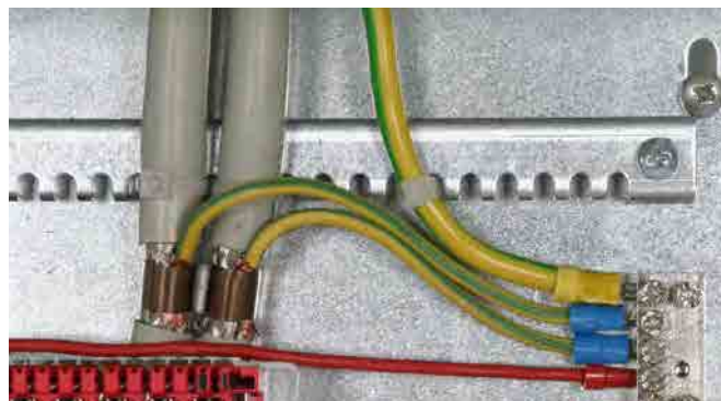
Sistema di connessione dello schermo per cavi particolarmente compatto con molla di contatto a nastro. Compensazione della riduzione dei materiali per i cavi utilizzati tramite effetto a molla.
