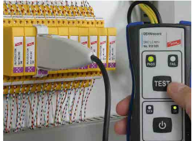
Verifica di un modulo di protezione tramite tecnologia RFID.
