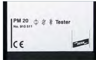
Si può controllare il comportamento di spinterometri a gas, varistori e diodi zener.
