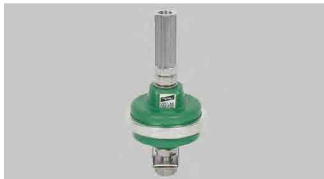
Per la separazione galvanica di scaricatori sovrccaricati dalla rete. Il disconnecter viene collegato in serie al cavo di terra degli scaricatori in media tensione.
