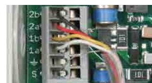
A scelta schermatura diretta o indiretta (DBX U4/U2 KT BD S 0-180).
