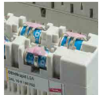
Blocco di protezione con tenuta alla corrente di fulmine con spinterometri a gas a scelta con indicatore ottico di guasto e funzione fail-safe.
