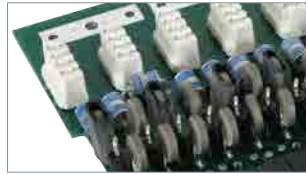
Variante con tecnica di connessione LSA come variante per il cablaggio per l'equipaggiamento iniziale degli impianti.
