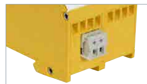
Collegamento di terra separato sul lato non protetto dell'apparecchio. Il secondo punto di fissaggio del morsetto doppio serve al collegamento diretto dell'apparecchio terminale con l'equipotenzialità.
