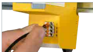
Collegamento del conduttore semplice e senza l'ausilio di attrezzi con tecnica a innesto diretto.
