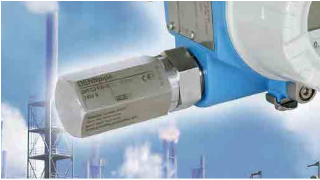
Limitatore di sovratensione per esterno, da avvitare sull'apparecchio in campo a 2 conduttori. Acciaio inossidabile, installazione con pressacavo fino a IP 67.
