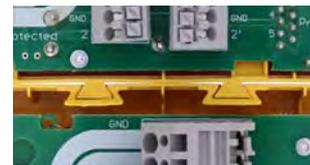
Aneinanderreihung mehrerer Geräte durch Stecktechnik der Gehäuse möglich (DBX TC B 180).
