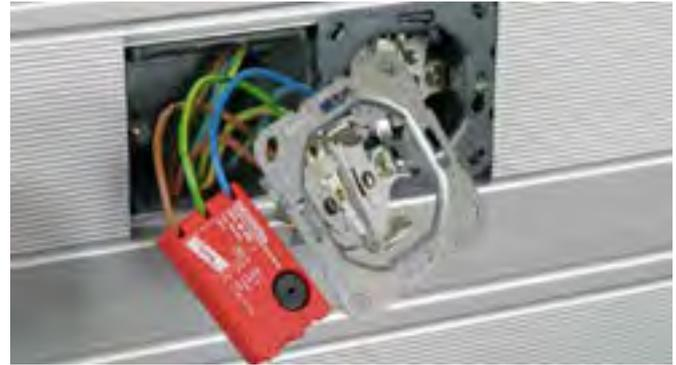
Zum Schutz von elektronischen Geräten vor Überspannungen. Zum Einbau in Elektroinstallationssysteme, wie z. B. Unterflursysteme, Kabelkanäle und Unterputzdosen. DE-Gebrauchsmuster für DEHNflex A / ... D. Zum Einsatz im Blitz-Schutzkonzept an Schnittstellen 1 – 2 und höher.
