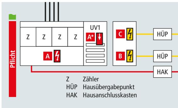
Bild 5 Schutzmaßnahmen für die eingeführten elektrischen Leitungen im MFH
