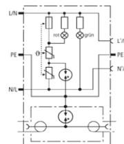
Kombinierter Überspannungsschutz für Energie- und Antennenseite eines Fernseh-, Rundfunk- oder SAT Receivers. Mit optischer Betriebs- und Defektanzeige und integrierter Kindersicherung.
