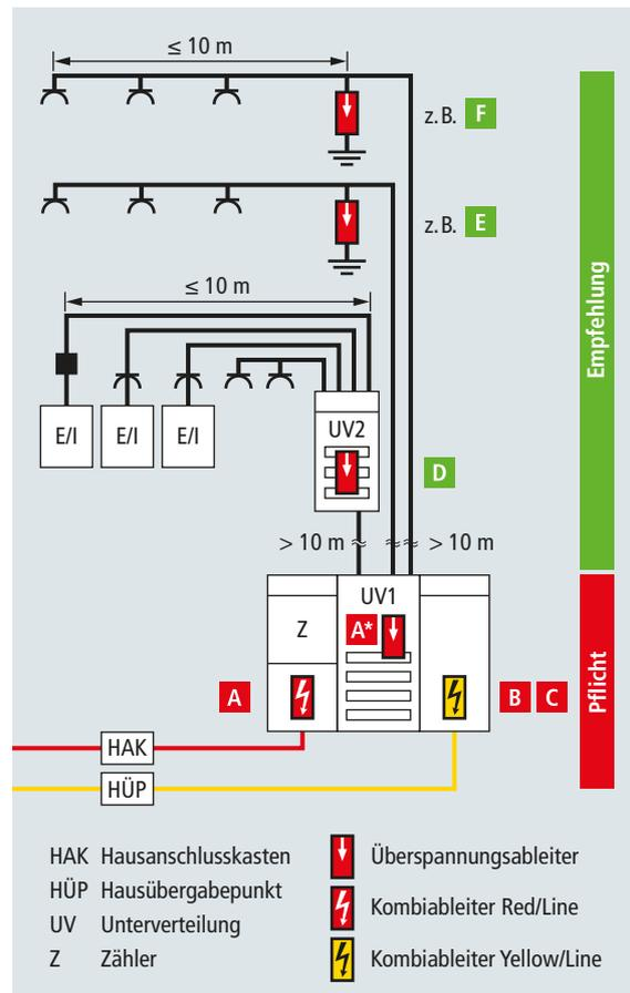
Bild 6 Weitere Überspannungsschutzmaßnahmen nach der „10 m-Regel“
