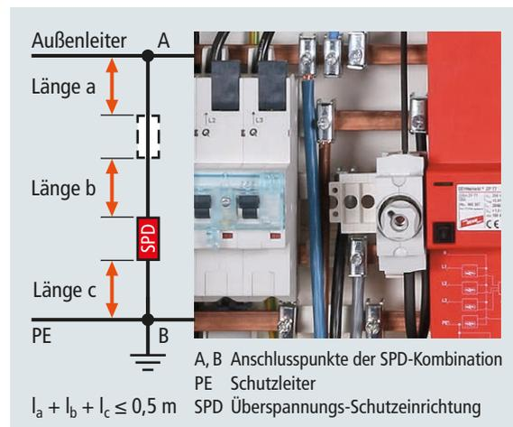
Bild 7 Verdrahtung des DEHNshield ZP Basic
